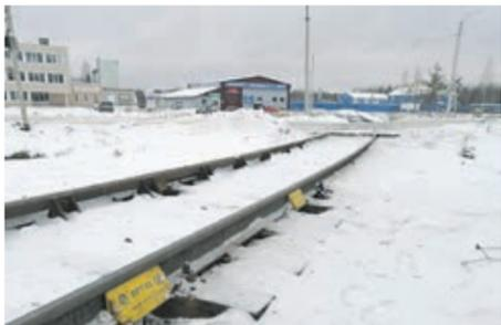
В Плесецком леспромхозе перед выходом с территории терминала установлены железнодорожные весы для взвешивания вагонов с готовой продукцией. Их наличие поможет избежать перегрузки ж/д составов. По требованию РЖД предстоит провести процесс поверки железнодорожной весоизмерительной техники.
